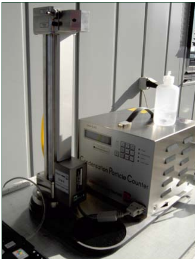
Abb. 6 Partikelkondensationskernzähler (links) mit elektrostatischem Klassifizierer (rechts)
